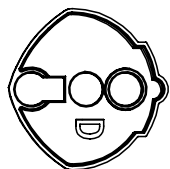
ADAPTADOR PARA SUPERFICIE CURVADA (CROWN VIC O CHARGER) P=LADO DE PASAJERO D=LADO DE CHOFEER
