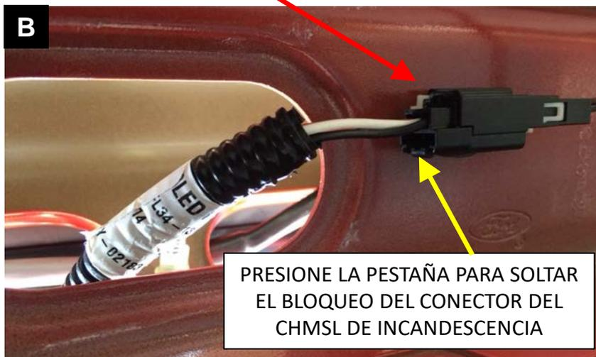
PRESIONE LA PESTAÑA PARA SOLTAR EL BLOQUEO DEL CONECTOR DEL CHMSL DE INCANDESCENCIA
