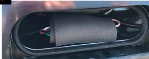
TIRANDO DEL MAZO DE CABLES 'P' DESDE LA COLUMNA C DEL LADO DEL CONDUCTOR, ELIMINE LA HOLGURA HASTA EL PUNTO DONDE LOS CONECTORES ENVUELTOS TODAVÍA ESTÁN ACCESIBLES EN CASO DE UNA NECESIDAD DE USO FUTURA
