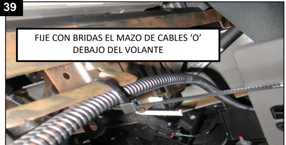
GUÍE EL MAZO DE CABLES DE ALIMENTACIÓN Y MASA 'O' A TRAVÉS DE LA CONSOLA CENTRAL HACIA LA CAJA DE FUSIBLES SITUADA EN EL LADO DEL PASAJERO DEL VEHÍCULO. ASEGURE EL MAZO DE CABLES CON BRIDAS. SE PUEDE UTILIZAR CINTA GUÍA COMO AYUDA PARA TIRAR DEL MAZO DE CABLES POR LA CONSOLA CENTRAL.
