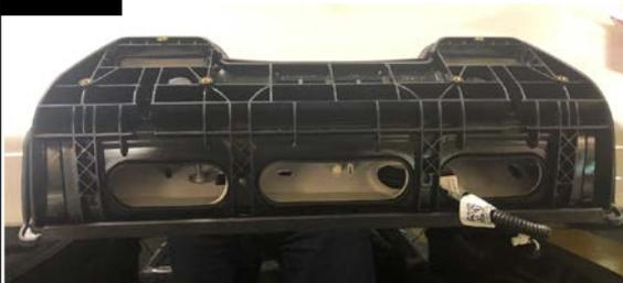
UNA VEZ SECADA LA ACETONA, VUELVA A COLOCAR LA BASE DE LA BALIZA EN EL VEHÍCULO
