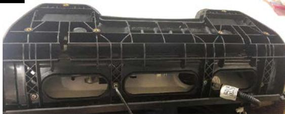
UNA VEZ FIJADO EL ADHESIVO DURANTE AL MENOS 20 SEGUNDOS, APRIETE LOS 4 TORNILLOS CON 2,6 – 3,2 NM CON UNA LLAVE Torx T-20 O UN VASO DE 7 mm
