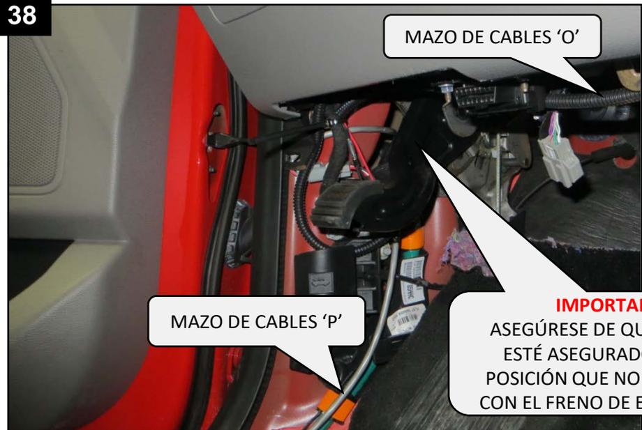
INTRODUZCA EL CONECTOR MACHO DEL MAZO DE CABLES 'P' EN EL CONECTOR HEMBRA DEL MAZO DE CABLES 'O' HASTA QUE QUEDEN BLOQUEADOS
