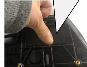
INSTALE LAS DOS PLACAS DE MONTAJE, 'F', RETIRANDO EL REVESTIMIENTO ANTIADHERENTE ROJO Y COLOCÁNDOLAS EN LA ABERTURA DE LA BASE DE LA BALIZA, CON EL LADO ADHESIVO HACIA ABAJO. APLIQUE UNA PRESIÓN FIRME DURANTE AL MENOS 20 SEGUNDOS EN CADA UNA.
