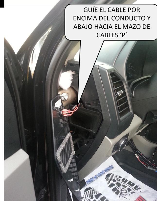
UNA VEZ RETIRADA LA MOLDURA DE FÁBRICA, SUSTITÚYALA POR LA MOLDURA CON INTERRUPTOR. GUÍE EL MAZO DE CABLES 'O' HACIA ABAJO AL CONECTOR DEL MAZO DE CABLES 'P'
