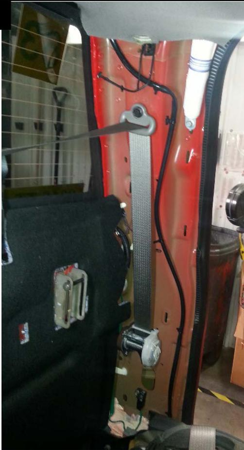
GUÍE EL MAZO DE CABLES 'P' A LO LARGO DEL MAZO DE CABLES EXISTENTE, UNIÉNDOLO CON BRIDAS A LAS CUATRO ANCLAS
