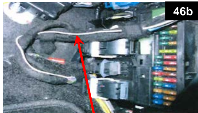
Fil de démarrage/contact fixé au faisceau J1 du BCM
